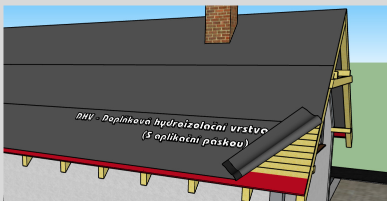
APLIKACE POJISTNÉ HYDROIZOLAČNÍ VRSTVY (DHV)
