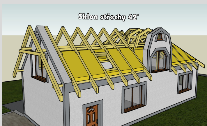
KONTROLA ROVINNOSTI A PŘÍPRAVA KROVU
